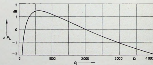
Bild 5. Schwingung \Delta P_L der an den Kopfhörer abgegebenen Leistung in Abhängigkeit von der Impedanz R_L des Kopfhörers (bezogen auf 2000 Ohm \pm 0 dB)
