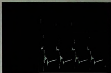
Bild 10. Sekundärbild eines Vierzylindermotors
